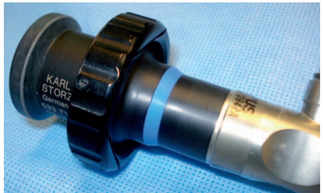
Abbildung 7: Adapter zum sterilen Wechseln zwischen verschiedenen Optiken (Fa. Storz, Tuttlingen, Deutschland)
